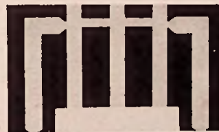
Bild 14. Dreiteiliger Bandpaß in symmetrischer Strip-Line-Technik
