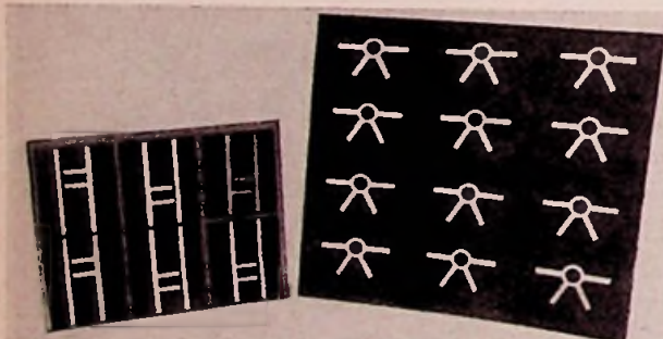
Bild 8. Microstrip-Leitungselemente, die nach der Technik der gedruckten Schaltungen hergestellt werden; links sechs Richtkoppler, rechts zwölf Hybriden (Verzweigungen). Die einzelnen Elemente können auseinandergeschnitten und in eine gedruckte Schaltung entsprechend eingesetzt werden
